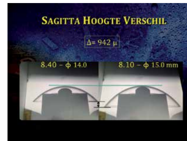
Sagitta hoogte verschil tussen een 8.40 lens met een diameter van 14.0mm en een 8.10 lens met een diameter van 15.0mm (bij gelijkblijvende geometrie). Het totale verschil bedraagt 942micron.
